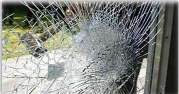
Splitterschutzfolien stabilisieren Glasflächen und schützen im Falle eines Bruchs vor Splitterflug. Der zwischen 115µ und 190µ starke Polyesterfilm verleiht dem Glas VSG-ähnliche Eigenschaften und damit eine hohe Widerstandskraft bei Glasbruch. Selbst wenn das Glas zerspringt, wird es durch die Folie zusammengehalten. Zusätzlich reduzieren sie die UV-Einstrahlung um bis zu 98 %. Je nach Anspruch lassen sich die Folien mit Zusatzeigenschaften wie Sonnen-, Blend- und/oder Sichtschutz kombinieren.
